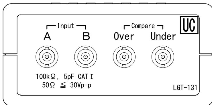
測定モードに応じて「Input」端子に「測定プローブ」を接続して計測します。
